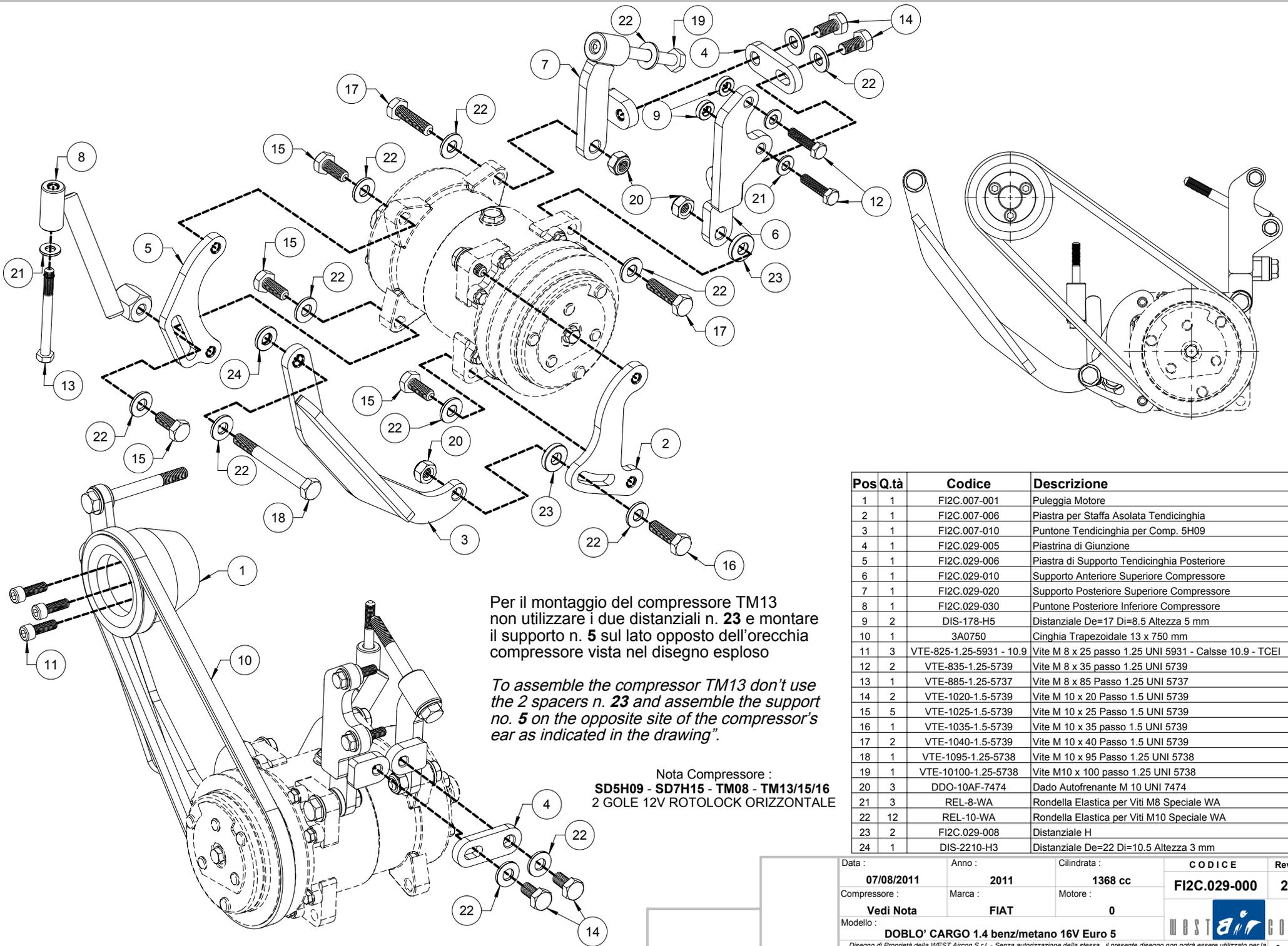
Per il montaggio del compressore TM13 non utilizzare i due distanziali n. 23 e montare il supporto n. 5 sul lato opposto dell'orecchia compressore vista nel disegno esploso
